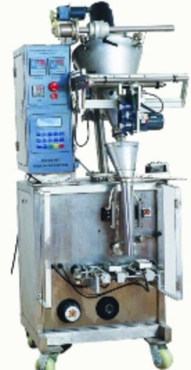
DB-120F (ระบบสกรู) เครื่องบรรจุสินค้าประเภทผง
